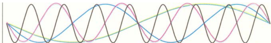
Преобразование Фурье разбивает сигнал на непрерывно повторяющиеся составляющие различных масштабов, поэтому оно неудобно для представления сигналов, быстро меняющихся во времени.
